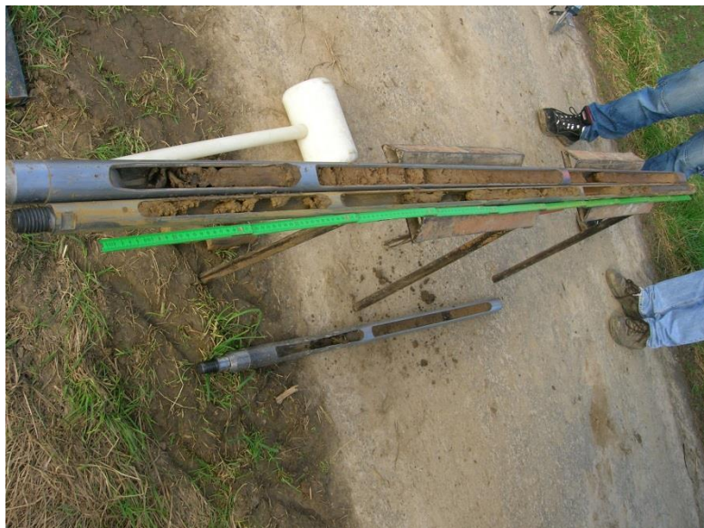
Foto 3: Auslage der erbohrten Bodenschichten bei S 2
