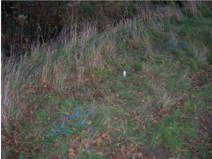
Foto 1: Bohrlotation S 10; sichtbar ist das eingestellte weiße Filterelement in das Sondierloch
