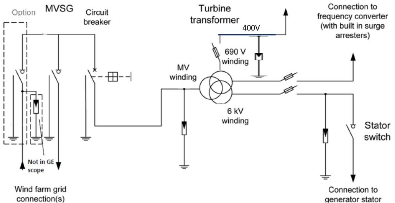
Abbildung 1: Überspannungsschutz des elektrischen Systems
